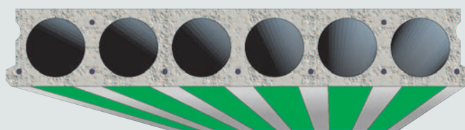
Зоны допуска для монтажа анкера fischer FHU
